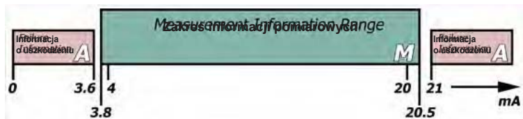
Rysunek 39 – Uszkodzenie wg NAMUR
