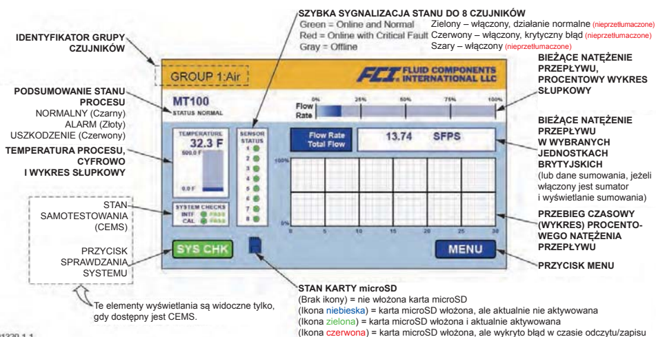
Rysunek 28 – Ekran wyświetlacza dla normalnej pracy MT100
