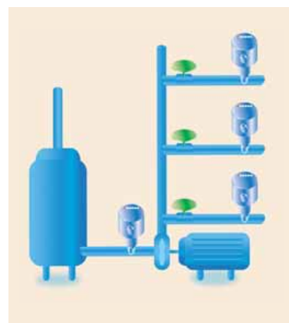
Rysunek 2: Ochrona przed suchobiegiem pompy zasilającej
