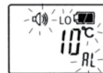
Zmiana wartości temperatury na 10°C przez użycie przycisku ▽/△
