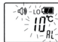
Ustawienie wartości temperatury za pomocą przycisku SET/ENTER.
