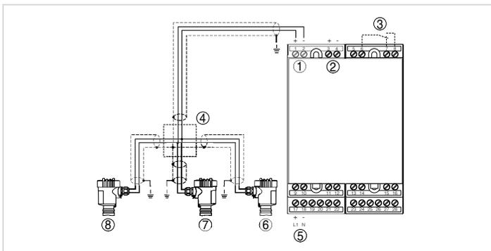
Ejemplo de conexión VEGASCAN 693 con sensores de dos hilos
